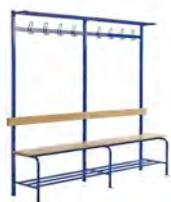
**Structure** : en profil métallique tubulaire composée d'un cadre supérieur de forme carrée 35\*35 mm ép. 1,4 mm et de 4 pieds.
